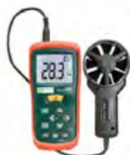
Anémomètre à hélice - Afficheur LCD - Gamme de mesure de la vitesse : 0,4...30 m/s - Précision de mesure de la vitesse : +/- 3% - Résolution de mesure de vitesse : 0,01 m/s - Amplitude de mesure de température: -10...60 °C - Exactitude de mesure de température : +/- 1 °C - Résolution de mesure de la température : 0,1 °C
